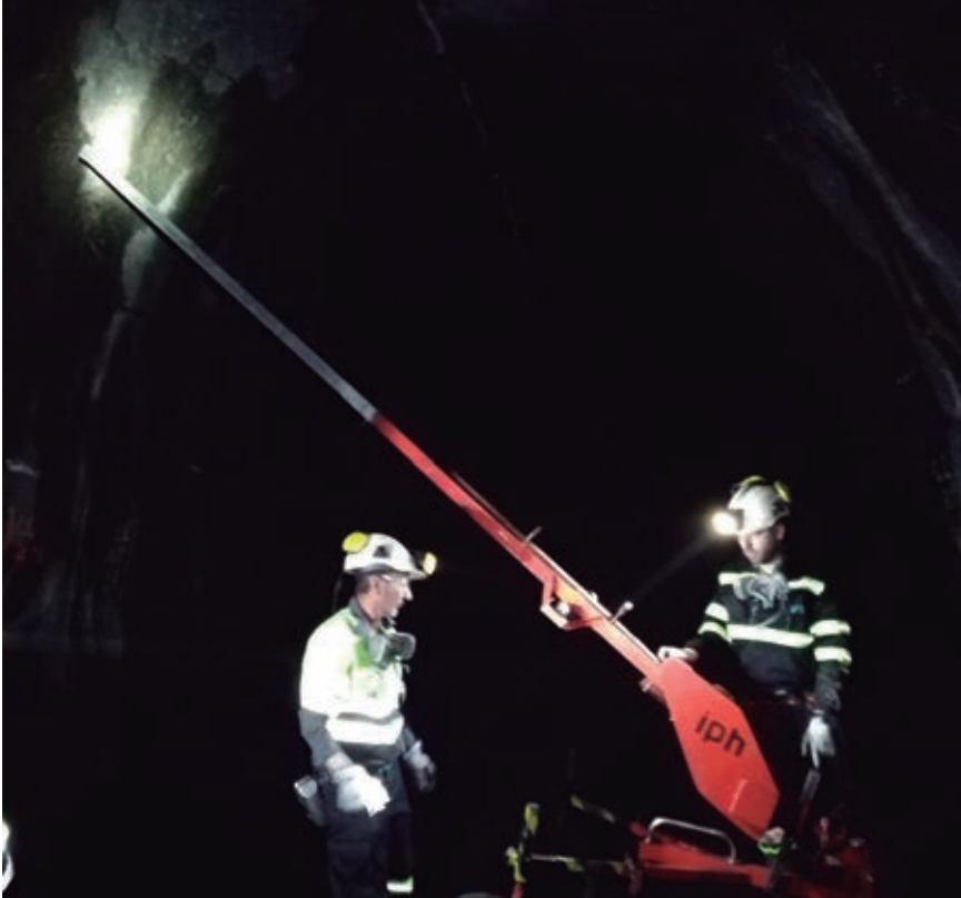
Medición de taladros en interior de mina mediante el uso del Sidal.
